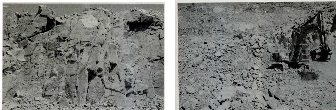
Εικόνα 1 Λατομείο σκληρού πετρώματος με έντονο κατακερματισμό.
