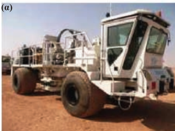
Σχήμα 5: (α) Υδραυλικός ταλαντωτής και (β) σχηματική απεικόνιση χερσαίας σεισμικής έρευνας [2]
