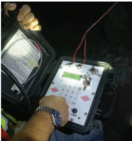
Πυροδότηση ηλεκτρονικών πυροκροτητών
