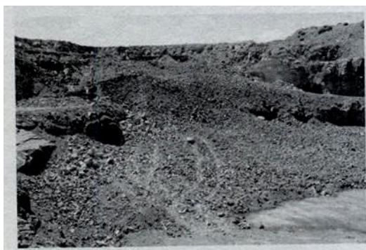
Εικόνα 3 Αποτελέσματα ανατίναξης με χρήση ηλεκτρονικών πυροκροτητών
